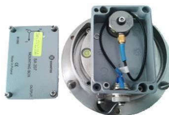
Figura 2: Sistema de montaje de acelerómetro Svantek SA 207
