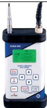
Figura 1: Analizador de vibraciones Svantek Svan948
