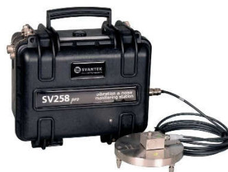
Figura 4: Sistema de montaje de acelerómetro Svantek SV258 Pro
